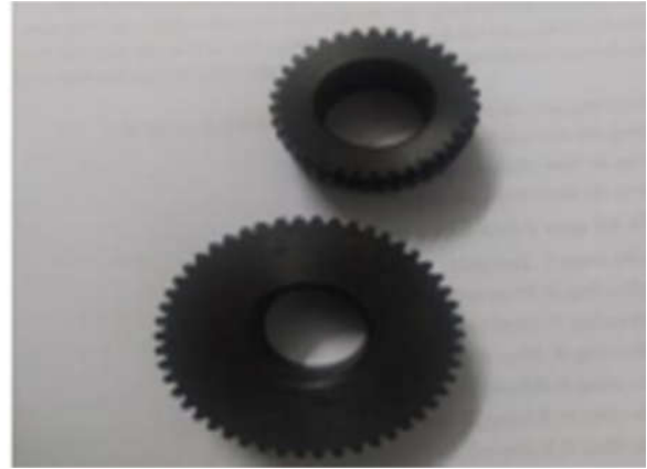
Hình 4. Bánh răng sau khi gia công kết quả kiểm tra bánh răng
